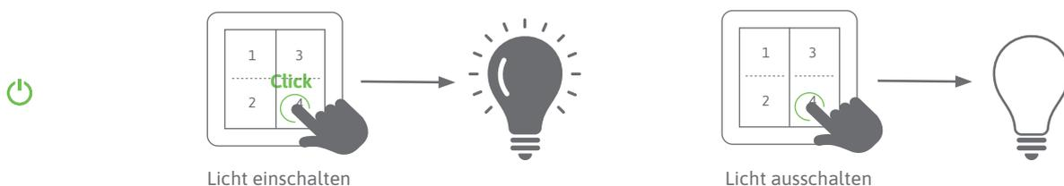
Hier wird ein Einfachklick dazu verwendet, die angeschlossene Lichtquelle mit der zuletzt verwendeten Farbe ein- oder auszuschalten. Dies entspricht der grundlegenden Funktion eines Schalters, bei dem mit einem einzigen Klick der Zustand der Beleuchtung geändert wird.
