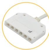
**USCITA:** scatola di distribuzione a 6 vie per il collegamento di ricevitori SIRO (max. 3A per collegamento, totale: 6A)
