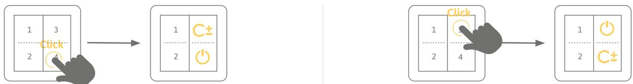
Durch Aktivieren der ersten Taste (Option 1) wird diese zu ON/OFF und automatisch die andere gegenüberliegende Taste (Option 2) zum Farbgler. Beim Aktivieren von mehreren Schaltern agieren diese als Wechselschalter.
