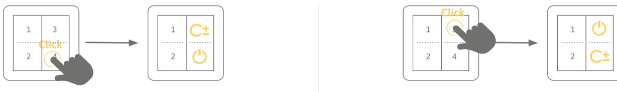
Durch Aktivieren der ersten Taste (Option 1) wird diese zu ON/OFF und automatisch die andere gegenüberliegende Taste (Option 2) zum Farbgler. Beim Aktivieren von mehreren Schaltern agieren diese als Wechselschalter.
