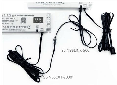
\* kann als 2 m Verlängerungskabel für das Link Kabel (SL-NBSLINK-500) und auch als Verlängerungskabel für die Sensoren (TOUCH, HIDDEN TOUCH, PIR, Door, Double Door), verwendet werden.
