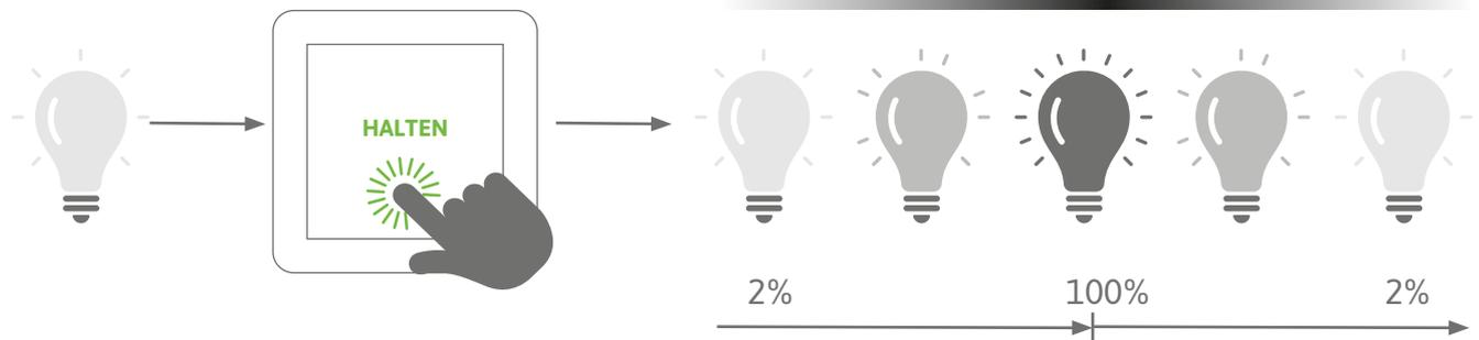
Ein längerer Druck auf den Schalter kann dazu verwendet werden, die Helligkeit oder Farbtemperatur stufenlos zu erhöhen oder zu verringern. Dies ermöglicht eine präzise Einstellung der Beleuchtung nach individuellen Vorlieben. Standardmäßig startet das Licht bei 50 % Helligkeit bzw. 0% Kaltweiß und 100 % Warmweiß bei DUO Systemen. Durch das Betätigen der Dimmfunktion (anhaltendes Drücken) startet das Licht mit dem zyklischen Dimmen.
