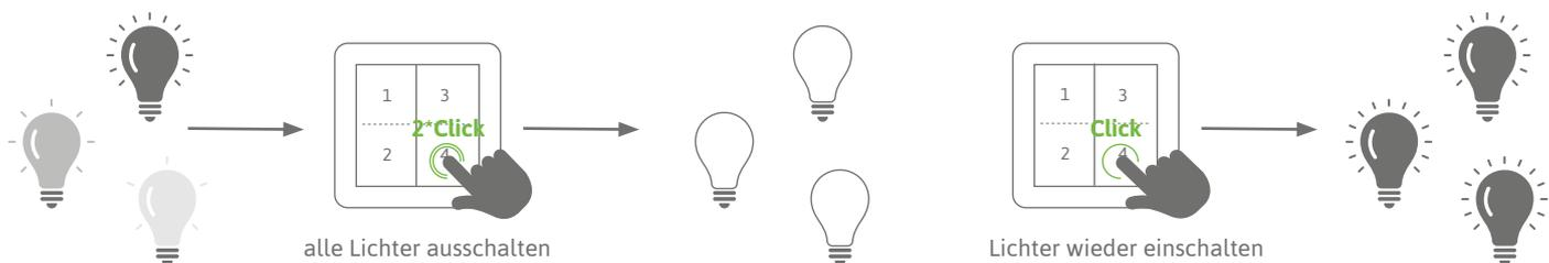
Alle Lichter werden ausgeschaltet. Diese Funktion wird zum Synchronisieren mehrerer Lichter verwendet wenn diese asynchron laufen.
