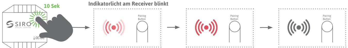
10 Sekunden drücken und gedrückt halten. Nun sind alle Verbindungen gelöscht und der Receiver ist bereit für eine neue Verknüpfung.
