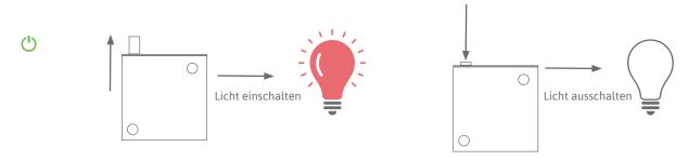
Bei SIRO Lichtschaltern wird ein Einfachklick dazu verwendet, die angeschlossene Lichtquelle ein- oder auszuschalten.
