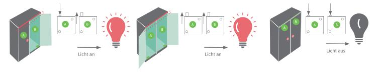
Sind 2 oder mehrere Türschalter mit einem Receiver verbunden, werden diese erkannt und es müssen **alle** gedrückt werden um die Lichtquelle auszuschalten. (alle Türen zu)
